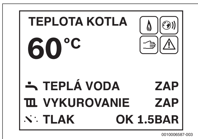
Obr. 5 Štandardné zobrazenie prevádzkového tlaku vykurovania
